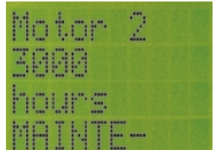
Figura 4: Display de LOGO! mostrando un mensaje y variable.
