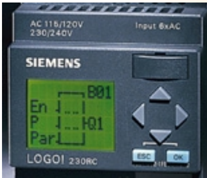
Figura 1: LOGO! mostrando en su display el bloque de función de mensajes
